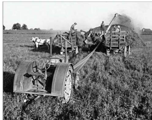
Figura 1.— Tractor que acciona una maquina trilladora de correa de la década de 1920 [1].
