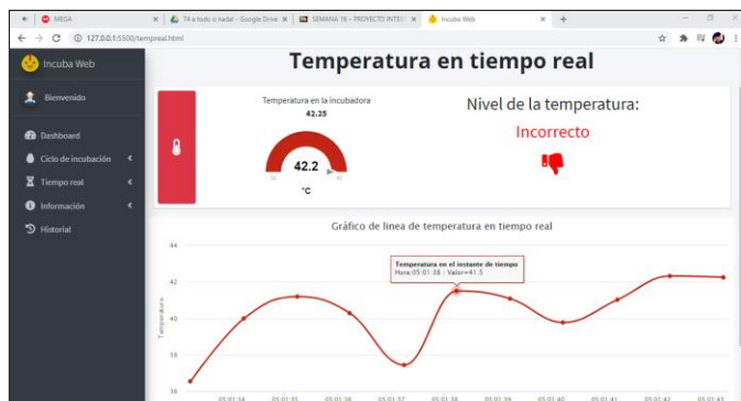
Ilustración 7. Prueba para la temperatura en tiempo real fuera de rango en el sistema de monitoreo.
