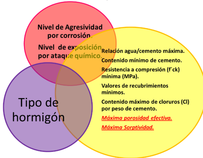
FIGURA NO. 3 PARÁMETROS TÉCNICOS E INTERACCIONES QUE CONSIDERAN LA NC 120: “HORMIGÓN HIDRÁULICO. ESPECIFICACIONES”, LA NC 250 “REQUISITOS DE DURABILIDAD PARA EL DISEÑO Y CONSTRUCCIÓN DE EDIFICACIONES Y OBRAS CIVILES DE HORMIGÓN ESTRUCTURAL”, Y LA NC 207: “REQUISITOS GENERALES PARA EL DISEÑO Y CONSTRUCCIÓN DE ESTRUCTURAS DE HORMIGÓN ARMADO”.
