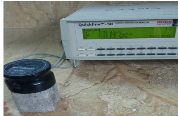
Fig3: L'appareil de mesure les propriétés thermo-physiques des matériaux
