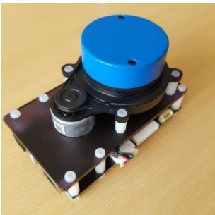
Şekil 6. Çalışmada mimari plan oluşturulmasında kullanılan LIDAR sensör
