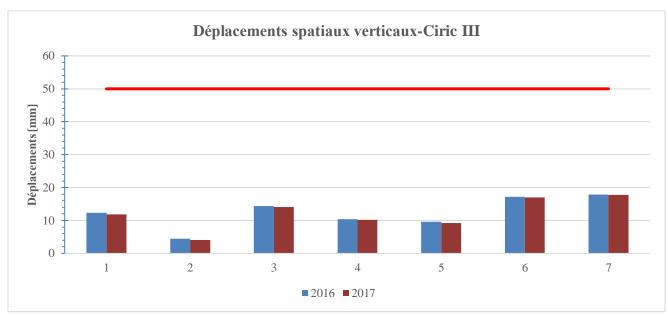
Figure 7. Déplacements spatiaux verticaux barrage Ciric III
