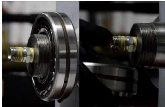
*Fig. 5. Desmontaje del rodamiento*
