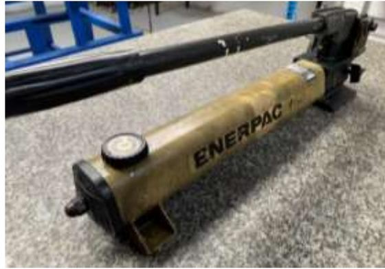
*Fig. 4. Bomba hidráulica manual*
