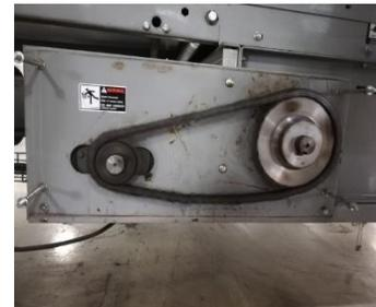
Figura 3.- Elemento de transmisión de potencia
